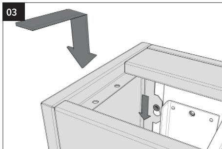
Haken Sie die Abdeckung in die mitgelieferten M6-Flanschschrauben ein. Ziehen Sie beide Schrauben links und rechts vom Gerät an.
