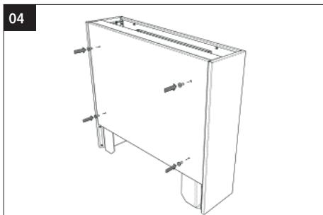
Installez le panneau arrière. Serrez avec les boulons plats, à la fois à gauche, au milieu et à droite de l'habillage.
