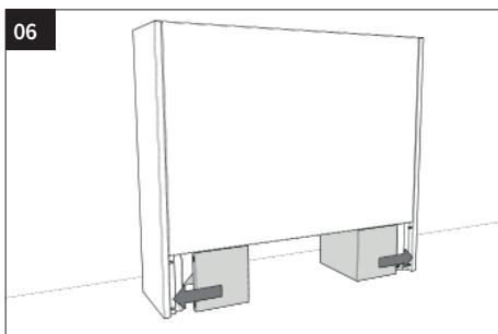
Schieben Sie die Füße unter die Abdeckung und schieben Sie sie in die Befestigungslöcher (Klicksystem).
