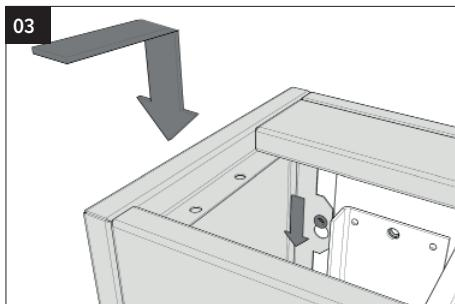
Accrochez l'habillage dans les boulons à bride M6 fournis. Serrez les deux boulons, à gauche et à droite de l'appareil.
