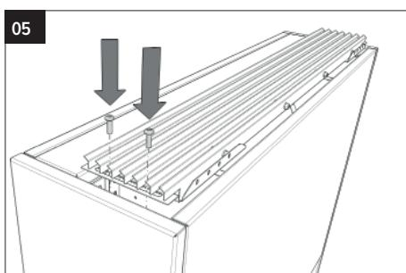
Montez la grille avec les vis, 2x à gauche et 2x à droite.
