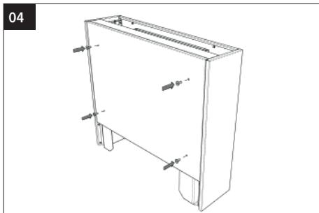
Befestigen Sie die Rückwand durch festziehen mittels den Flachschrauben links / in der Mitte / rechts der Abdeckung.
