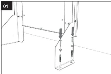
Bohren Sie Löcher in den Boden und befestigen Sie diese mittels korrektem Montagematerial.
