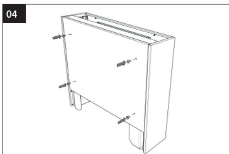
Breng het achterpaneel aan. Draai vast met de vlakke bouten, dit zowel links/midden/rechts van de bekleding.
