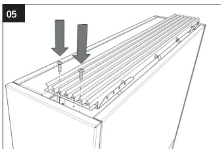
Befestigen Sie das Gitter mit den Schrauben 2x links und 2x rechts.
