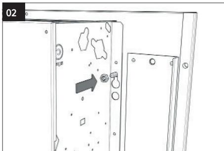
Duw de bouten met plat vlak door de achterplaat naar de voorzijde, haak het toestel in. Draai de moer op de bout en zet vast.
