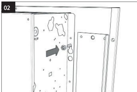
Poussez les boulons avec une surface plane à travers la plaque arrière vers l'avant, accrochez l'appareil. Vissez l'écrou sur le boulon et serrez.
