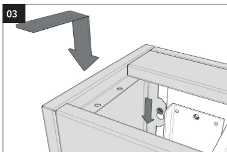
Haak de bekleding in de voorziene M6 bouten met flens. Draai beide bouten vast, dit zowel links als rechts van het toestel.
